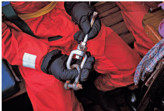
16 Millimeter stark ist der Edelstahlwirbel, der zwischen Kette und Ankerschaft eine sichere Verbindung schaffen sollte. Lochfraß hat ihn jedoch so geschwächt, dass er brach – zum Glück war ein zweiter Anker ausgebracht
